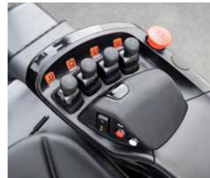
L'interruttore di emergenza è facilmente accessibile per poterlo attivare rapidamente in caso di bisogno.
