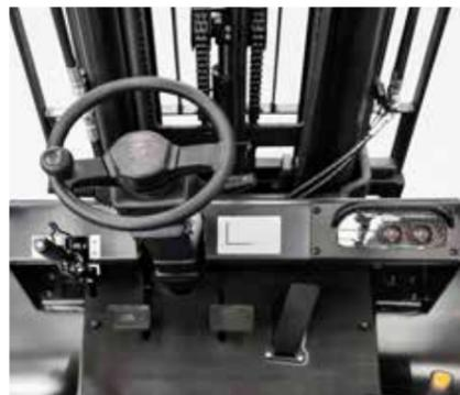
Per un maggiore comfort, abbiamo spostato il piantone dello sterzo a sinistra per una postura più naturale, mentre il cruscotto è stato spostato a destra per una migliore visibilità.
