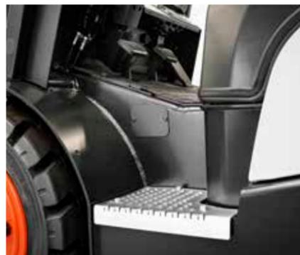
I nostri carrelli elevatori sono progettati pensando al comfort dell'operatore, con gradino di accesso basso anti-scivolo e pratica barra di ingresso.
