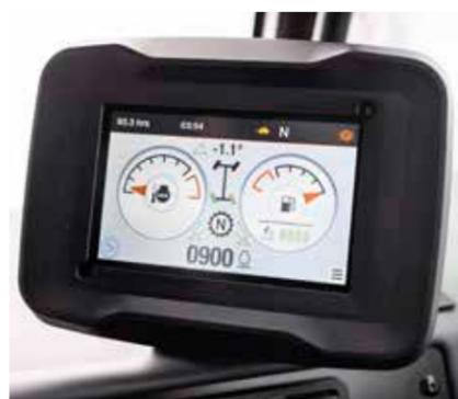
Lo schermo interattivo chiaro e leggibile mostra tutte le informazioni importanti in tempo reale. Il feed della telecamera posteriore viene visualizzato automaticamente quando innesti la retromarcia (opzionale).
