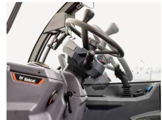
Sistema di regolazione telescopica e inclinazione del piantone dello sterzo
