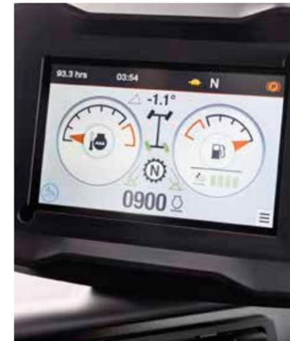
Display LCD da 5" con comando jog per la navigazione
