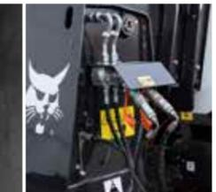
Linea idraulica ausiliaria sulla testa del braccio con FCS\*
