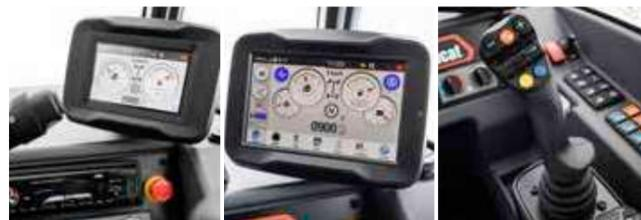
Display da 5" standard con radio Bluetooth, microfono e altoparlanti | Display touch screen da 7" (radio Bluetooth con microfono e Job Manager) | Joystick Smart
