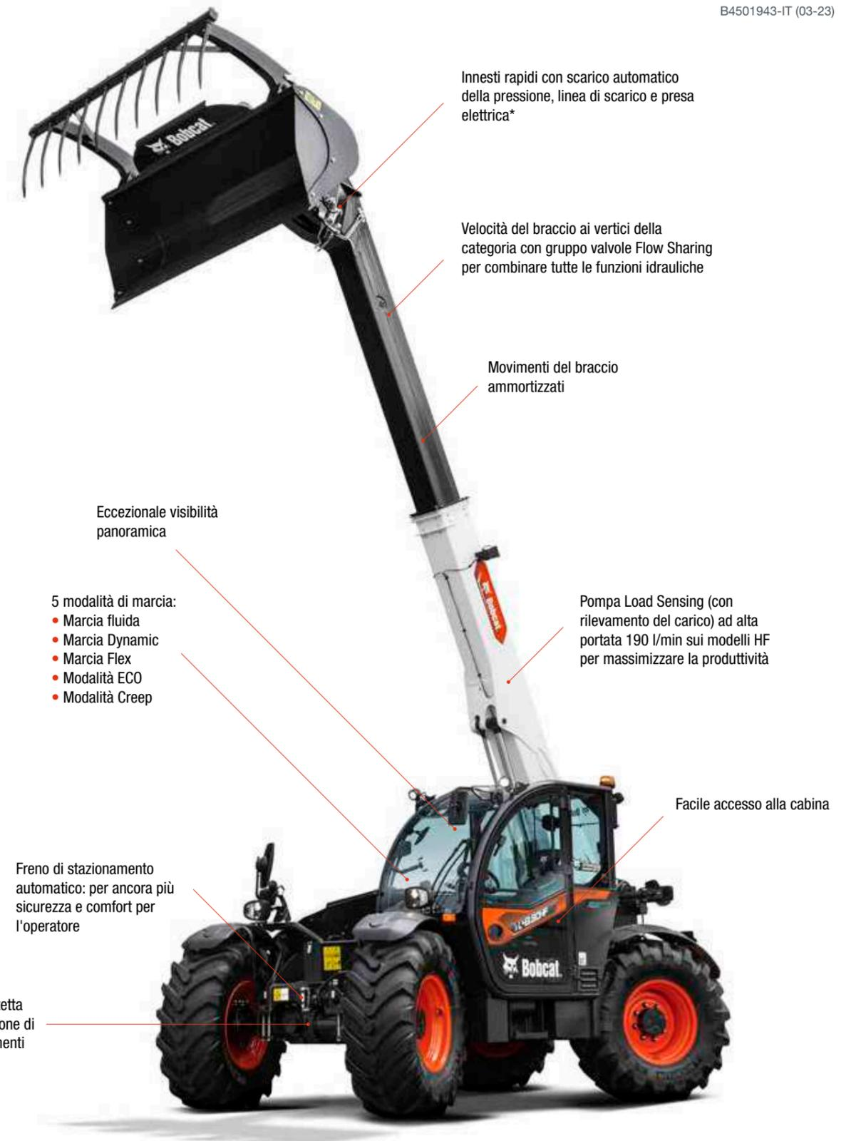
Innesti rapidi con scarico automatico della pressione, linea di scarico e presa elettrica\*
