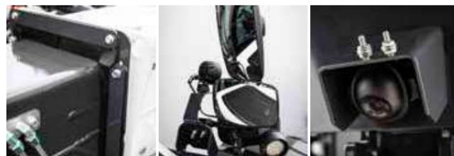
Protezione antipolvere sul braccio | Specchietto elettrico con sghiacciatore sul lato destro | Telecamera posteriore
