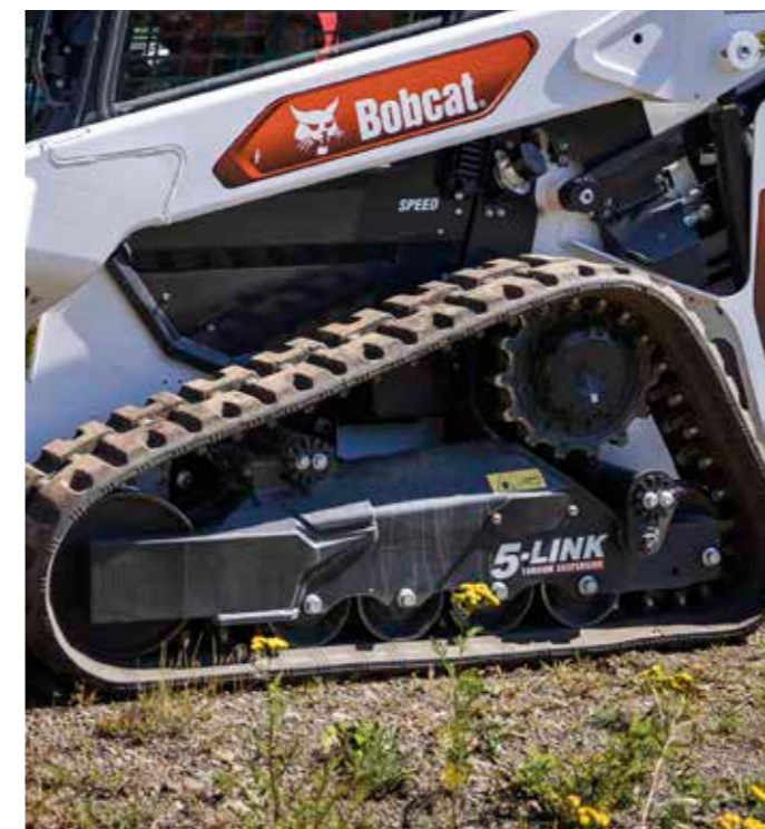
Sistema di sospensioni a torsione a 5 punti
