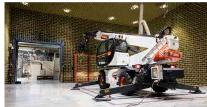
Il modello TR60.250 usa la doppia alimentazione - motore completamente elettrico
