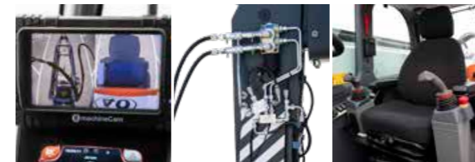
Display della telecamera Bloccaggio idraulico accessori Sedile a sospensione pneumatica ultra confortevole con poggiatesta
