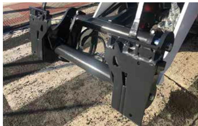
Adattatore da Quick-Tach a Bob-Tach (necessario per tutti gli accessori ad eccezione di benne e forche per pallet)
