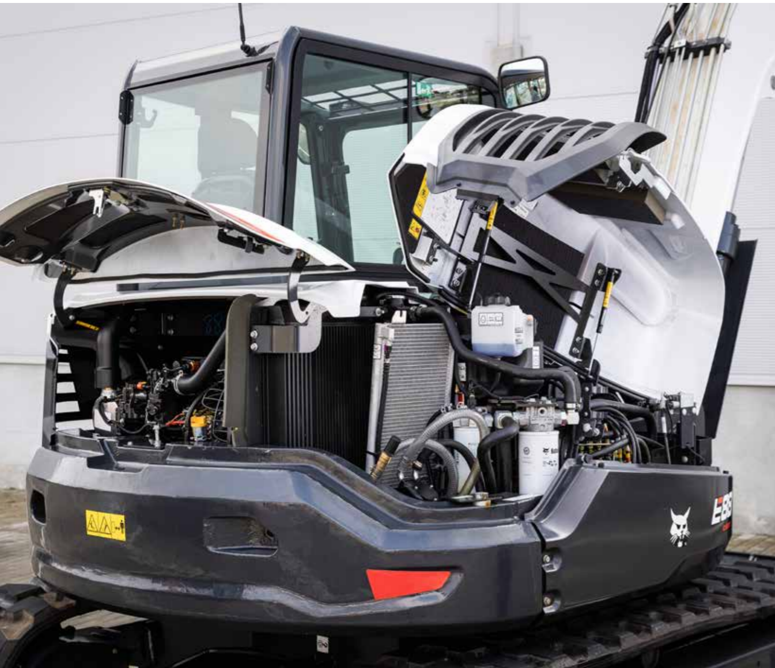
Manutenzione più facile grazie alle ampie coperture
