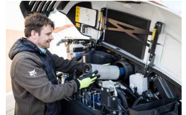
Sostituzione dei filtri
