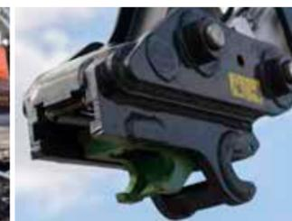
A presa di perno idraulico
