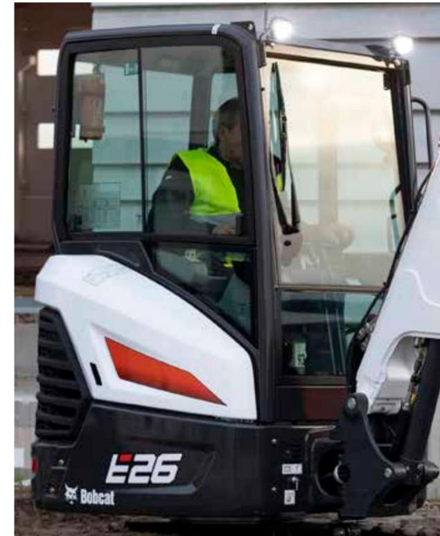
Cabina TOPS/ROPS/FOPS con riscaldamento
