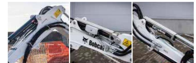
Predisposizione per pinza Copertura per cilindro benna Copertura per cilindro avambraccio
