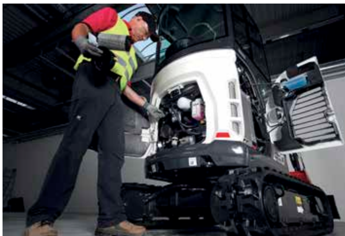
Sostituzione dei filtri
