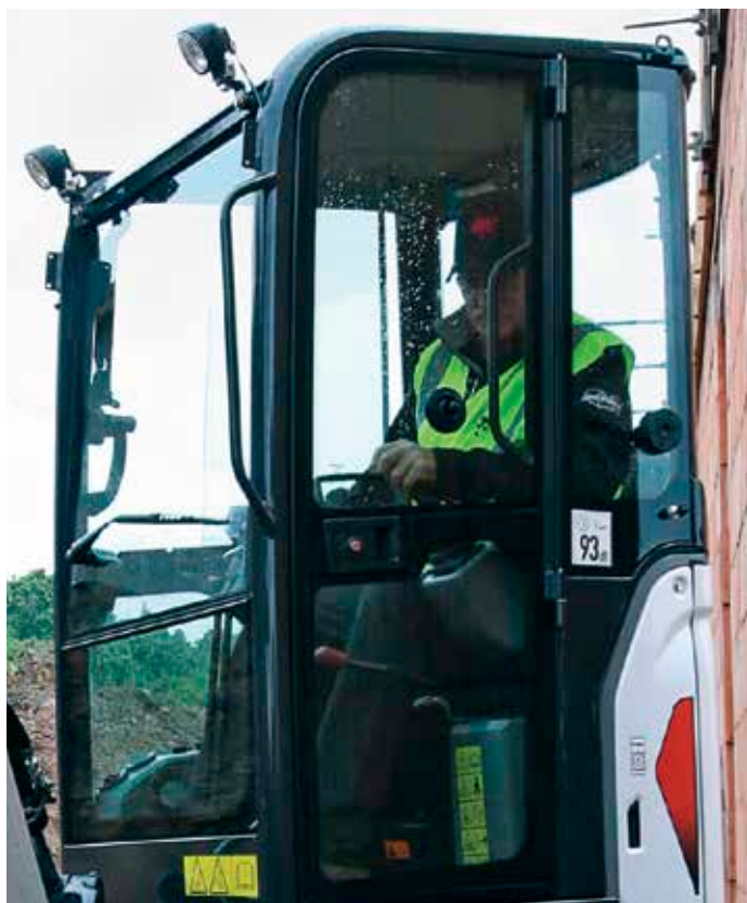
Cabina TOPS/ROPS con impianto di riscaldamento
