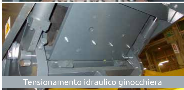
Regolazione idraulica per prevenire intasamenti
