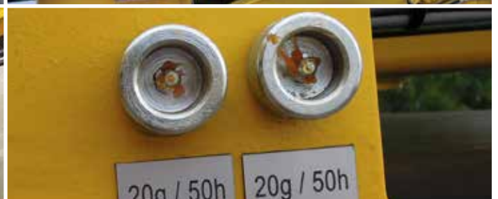
Punti di ingrassaggio protetti
