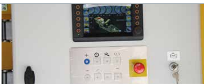
Pannello di controllo Relytec con PLC
