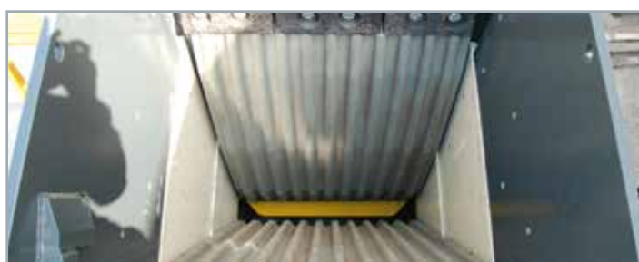
Regolazione idraulica per prevenire intasamenti
