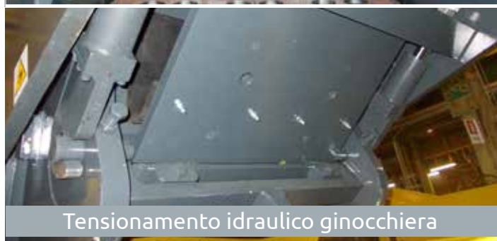
Regolazione idraulica per prevenire intasamenti
