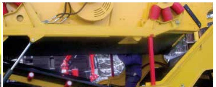
Cassa vaglio sollevabile idraulicamente
