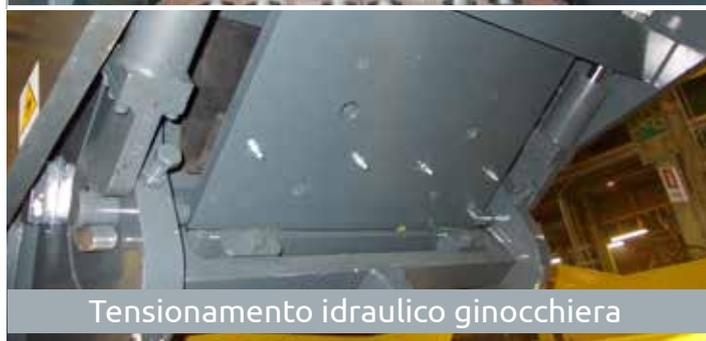
Tensionamento idraulico ginocchiera
