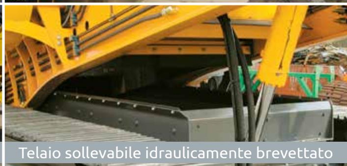
Telaio sollevabile idraulicamente brevettato
