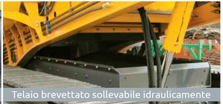
Telaio brevettato sollevabile idraulicamente
