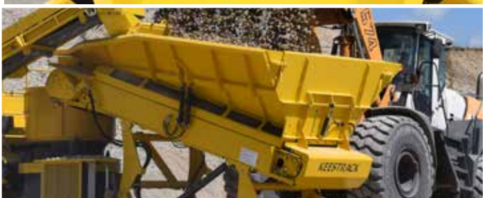
Pareti tramoggia ripiegabili idraulicamente
