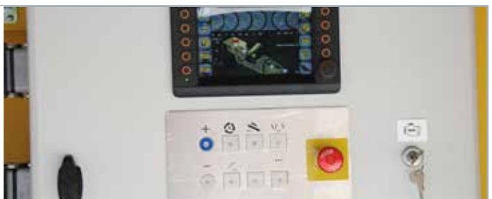
Pannello di controllo Relytec con PLC
