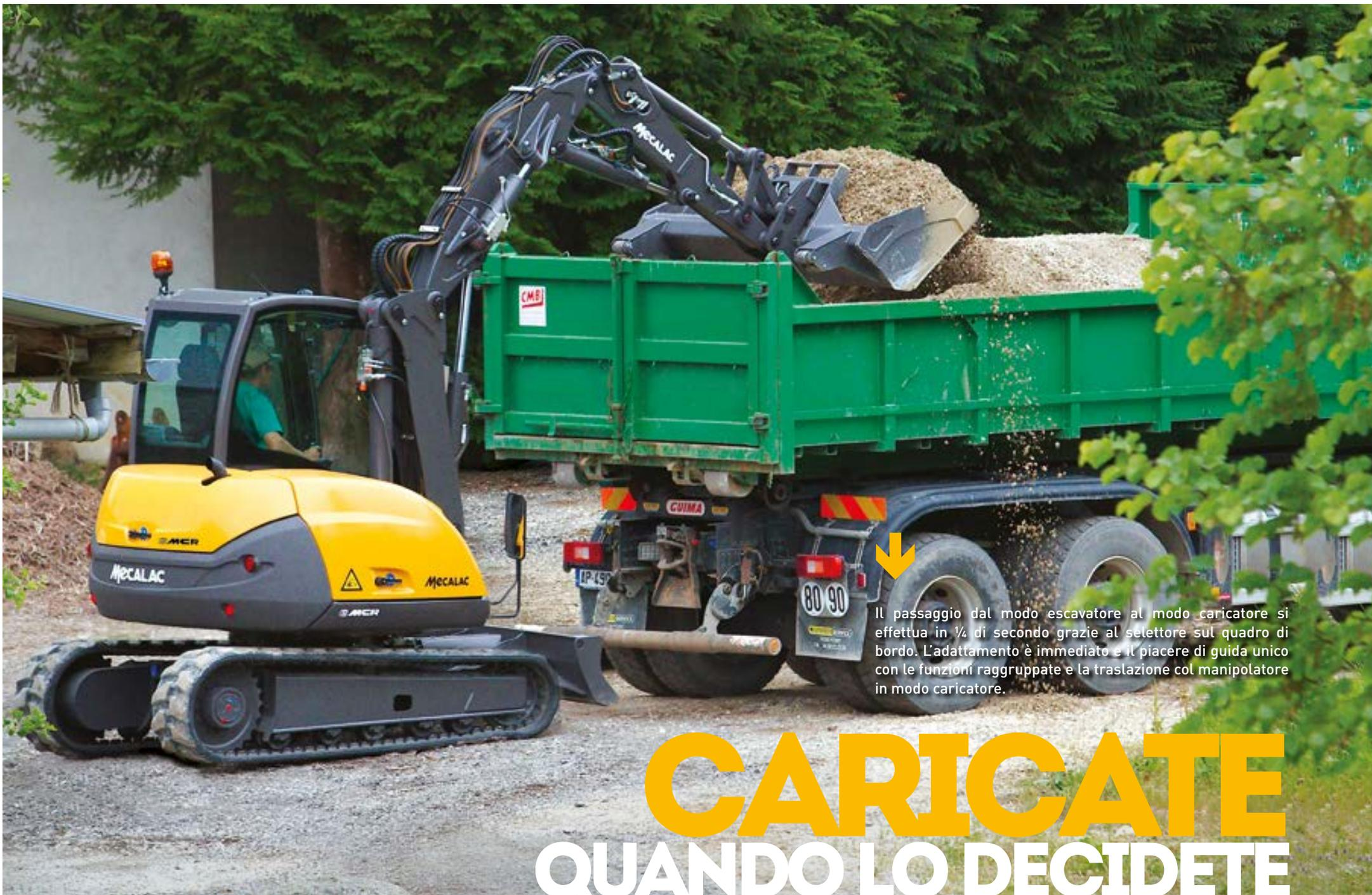
Il passaggio dal modo escavatore al modo caricatore si effettua in 1/4 di secondo grazie al selettore sul quadro di bordo. L'adattamento è immediato e il piacere di guida unico con le funzioni raggruppate e la traslazione col manipolatore in modo caricatore.
